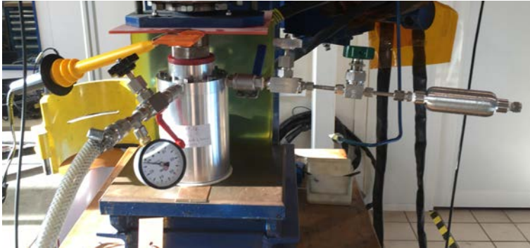
Fig. 2. Vue de l'ensemble du dispositif, fermement maintenu dans une presse à cause de la violence des décharges. Le manomètre sert à vérifier le vide primaire dans la cavité avant la décharge. Le gaz est recueilli dans la petite bonbonne en inox sur la droite, une fois la décharge effectuée. Il est ensuite envoyé à l'analyse.
