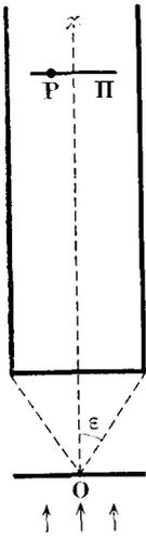
L'objet ponctuel est placé sur le porte-objet du microscope et bombardé de corpuscules arrivant normalement au porte-objet par en dessous : nous le supposons au repos dans son état initial ;  $\lambda$  désignera la longueur d'onde  $\frac{h}{p}$  des corpuscules « éclairants ». Nous supposerons négligeables toutes les aberrations géométriques, nous plaçant ainsi dans un cas plus favorable que la réalité.
